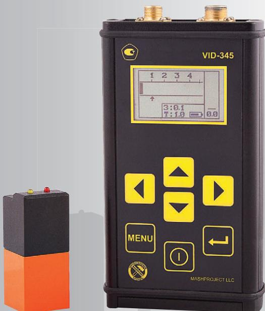
O detector de defeitos por correntes parasitas magnéticas VID-345 fabricado pela NPP "Mashproject" foi projetado para detectar e determinar a profundidade das rachaduras (por corrosão sob tensão) em estruturas metálicas, inclusive sob a camada de revestimento isolante e/ou corrosão. O detector VID-345 também é usado para controlar a espessura do revestimento de isolamento no produto controlado.
