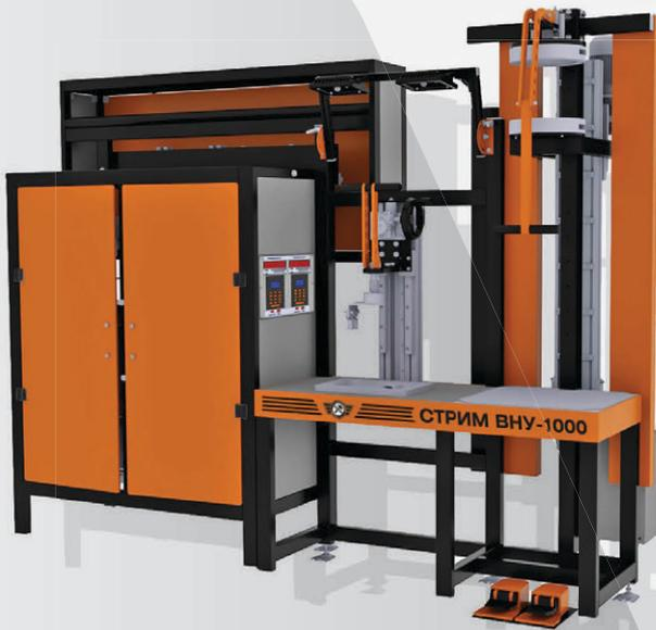
As instalações estacionárias para detecção de defeitos por partículas magnéticas (DPM) são projetadas para detectar defeitos superficiais e subsuperficiais durante a inspeção de produtos feitos de materiais ferromagnéticos. Elas detectam rachaduras, flocagens, faltas de fusão, áreas não soldadas e outros defeitos.
