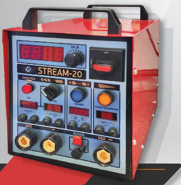
O detector de defeitos por partículas magnéticas STREAM fabricado pela Mashproject é projetado para ensaios não destrutivos de produtos metálicos. O dispositivo é projetado para detectar defeitos superficiais e subsuperficiais na inspeção de produtos de materiais ferromagnéticos. Detecta rachaduras, flocagens, não fusões.
