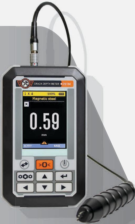
O fissurômetro 281M-C fabricado pela NPP "Mashproject" é um dispositivo portátil de alta precisão para medir a profundidade das fissuras que chegam à superfície de produtos feitos de vários metais e ligas (incluindo aço inoxidável, duralumínio, titânio), previamente detectadas por qualquer outro método.
