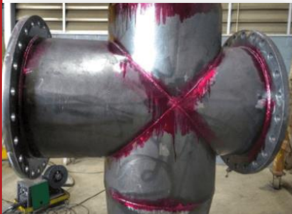
Inspeção por L.P
